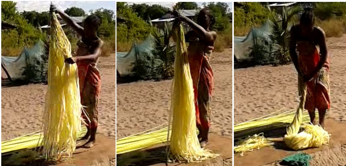
4- les fibres obtenus sont regroupées puis enroulées pour le séchage
