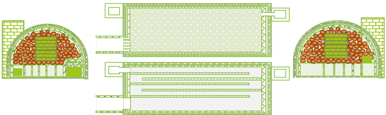
Figure 3. Le four GMDR 2 : vue en coupe et en élévation.
