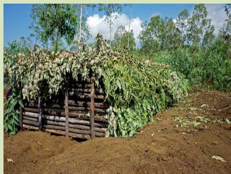
La « Voay Mitapy » est pourvue d'évents latéraux qui permettent de diriger les flux d'air dans la meule. A la différence de la « MATI » munie de cheminée, les fumées sont évacuées par une bouche de sortie creusée à même le sol au pied de la meule.
