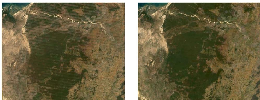
**Figure 8 : Extrait d'une image composite de 2010 produite à partir des données Landsat 5 et Landsat 7 SLC-off (à gauche) et d'une image composite produite uniquement à partir des données Landsat 5 (à droite)**
